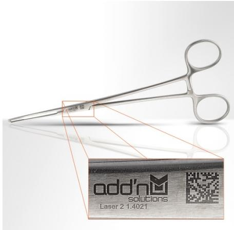
Anlassbeschriftung auf medizinischer Edelstahlschere nach 500-facher Wiederaufbereitung: Die UDI-Markierung ist klar lesbar, da Edelstahl-geeignete Lasermarkier-Parameter in Kombination mit der Passivierung das Instrument langandauernd vor Korrosion schützen und die Markierung haltbar machen.
